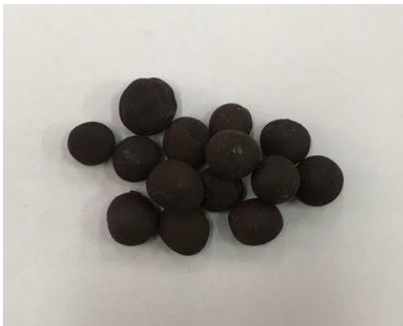
13 Сурет – Тәжірибеде алынған шикі жентектердің үлгісі
