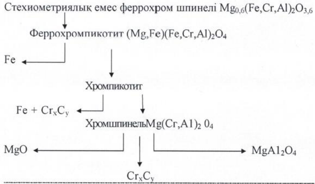
1 Сурет–Хром кенінен темір мен хромды көміртегімен тотықсыздандыру сұлбасы
